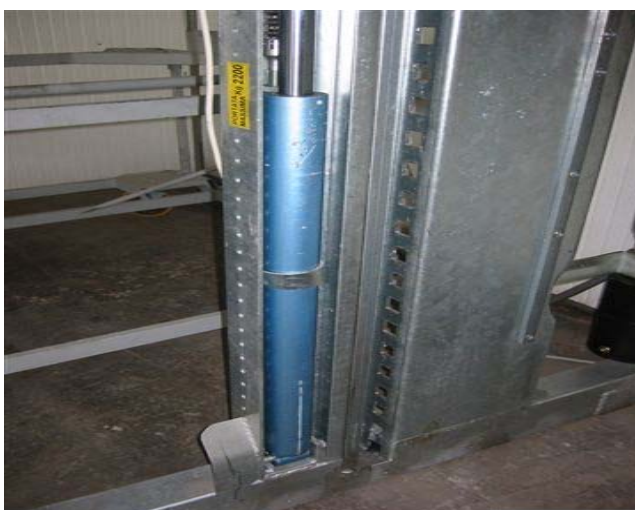
Particolare della cremagliera di stabilità del carico e cilindro di spinta
